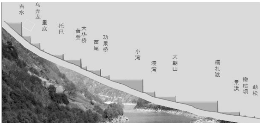
图 8: 澜沧江水电梯级开发的示意图, 资料来源: 同图 7。
